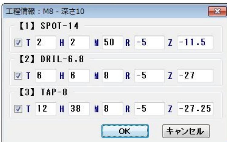
次に、開始要素を聞いてきますので、M8 の穴を選択すると同じ条件（穴径・線種・色）の要素を検索して自動で加工します。
